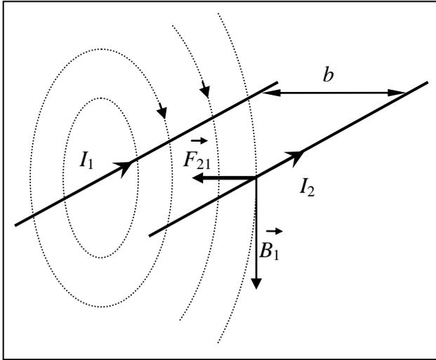
лельных прямых проводников с токами  $I_1$  и  $I_2$ , расстояние между которыми равно  $b$ .
