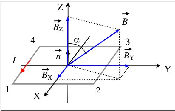
3) Рассмотрим случай, когда вектор  $\vec{B}$  направлен произвольным образом. Введём декартову систему координат, начало которой поместим в центре прямоугольника, ось  $Z$  направлена вдоль нормали, а оси  $X$  и  $Y$  параллельны сторонам прямоугольника.
