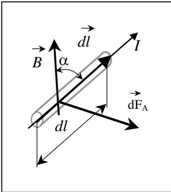
Магнитное поле проявляется по силовому воздействию на проводники с током. Такая сила была впервые определена А. Ампером в 1820 году при экспериментальном исследовании силового взаимодействия проводников с токами. Опыт показывает, что на прямолинейный проводник с током в однородном магнитном поле действует сила, зависящая от силы тока, индукции магнитного поля, длины проводника и положения проводника относительно силовых линий магнитного поля. Эта сила называется **силой Ампера**.
