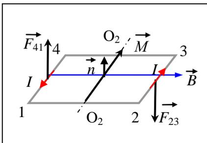
2) Пусть  $\alpha=\pi/2$  и вектор  $\vec{B}$  параллелен стороне 12. В этом случае  $F_{12} = F_{34} = 0$ ,  $F_{23} = F_{41} = IBb$ . Сумма сил равна нулевому вектору, но суммарный момент сил равен моменту пары сил (например, относительно оси  $O_1O_2$ )
